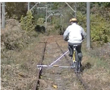
草刈り作業等の移動用・資材運搬用に開発中の軌道自転車 (碓氷線の急勾配に対応可能なことを実証済み。)
